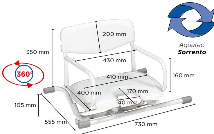
**Seggiolino con seduta girevole** per vasca da bagno, struttura in plastica ABS ad alta resistenza ed in acciaio di alta qualità zincato e verniciato epossidico.
